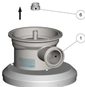
**E=** Extraire la partie rotative de la garniture mécanique (6) en faisant tourner le ressort dans le sens antihoraire.
