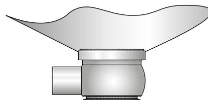
entre la bride et la plaque du réservoir. Effectuer une soudure par points toujours sur le côté opposé (8 segments avec métal d'apport). Si possible souder la racine sans métal d'apport. La soudure finale doit être effectuée en 8 segments afin d'éviter toute formation de fissures.
